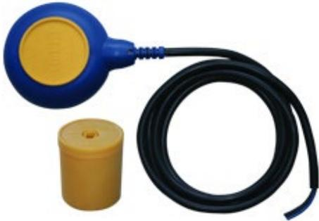
Este interruptor de flotador cuenta con 3 metros de cable y con contrapeso para ajustar la altura de la boya, la principal función es la de poner en marcha y detener la bomba automáticamente en función del nivel de agua.
