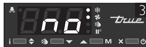
Imagen 3. Si la palabra "no" aparece en la pantalla, el controlador está desbloqueado..
