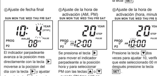
El indicador parpadeante avanza a la posición mes directamente con la tecla **▶** moverse a la posición del día con la tecla **▶** y ajustar 4 con la tecla **▲**, después presione la tecla **SET**.
