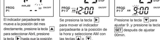
El indicador parpadeante se mueve a la posición del mes directamente, presione la tecla **▶** para seleccionar Abril, presione la tecla **▶** hasta que la posición del día parpadee. Ajustar 7 con la tecla **▲** y después presionar la tecla **SET**.
