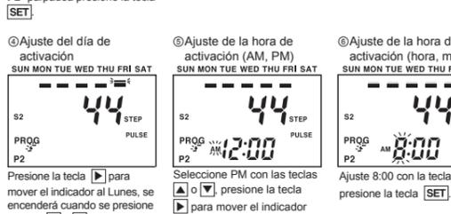
Al presionar la tecla **MODE** por 3 seg, en el modo RUN, "PROG P1" parpadea, presione de nuevo la tecla **MODE**, "PROG P2" parpadea presione la tecla **SET**.
