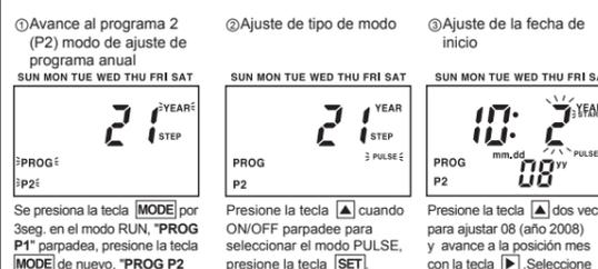
Se presiona la tecla **MODE** por 3seg, en el modo RUN, "PROG P1" parpadea, presione la tecla **MODE** de nuevo, "PROG P2 YEAR" parpadea, presione la tecla **SET**.
